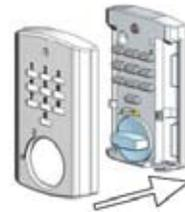
Setzen Sie die Abdeckkappe auf das Grundgehäuse und lassen sie diese mit leichtem Druck einrasten.
